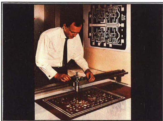
Fig. 43 - Circuito integrato a semiconduttori - Fabbricazione di modelli di maschere.
