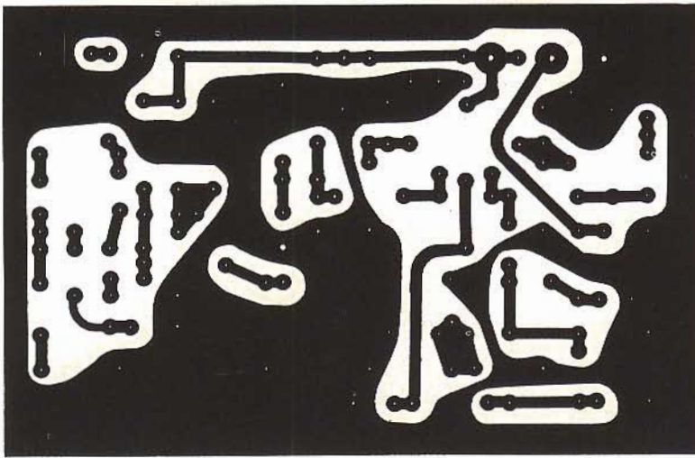
Fig. 6 - Circuito stampato del convertitore in scala 1:1 visto dal lato del rame.
