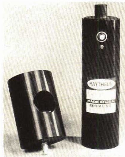
Fig. 4 - Rivelatore fotovoltaiico di raggi infrarossi funzionante nella gamma compresa fra 8 e 12 micron. Tempo di risposta 15 ns.
