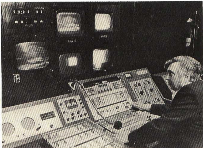
Fig. 5 - Foto illustrante una complessa apparecchiatura, mediante la quale è possibile abbinare numerosi effetti di commutazione in una rete televisiva.
