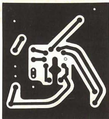
Fig. 9 - Circuito stampato dell'amplificatore a grandezza naturale.
